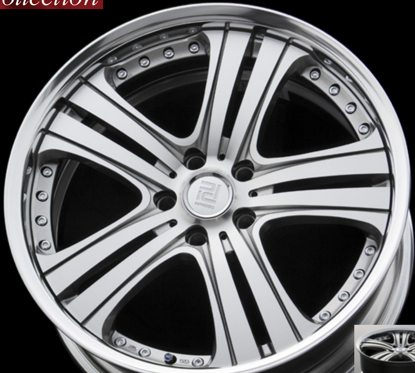
ディスク面は、センターに落とし込みを持たせているのが特徴。さらに、2ピース構造ならではのディープリムも魅力的だ。
